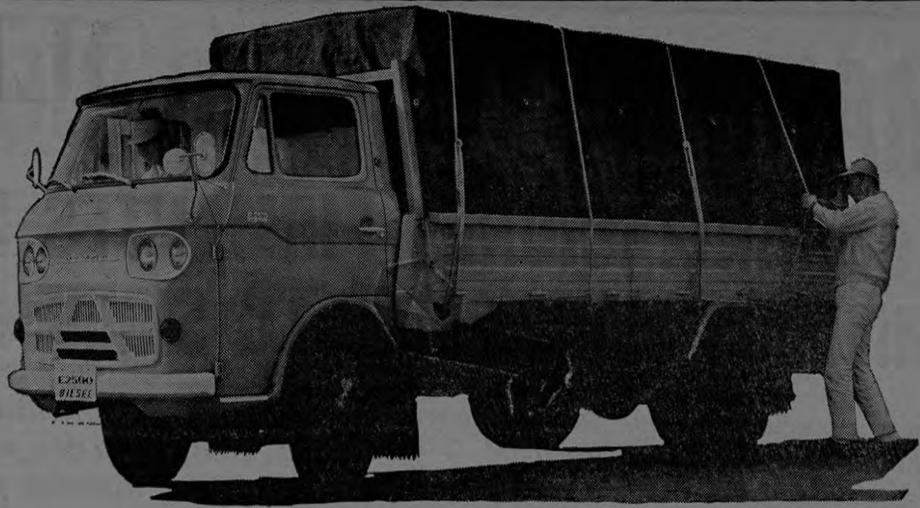
CAMION MAZDA DIESEL - E-2.500 Diseñado para largas distancias y altas velocidades, con motor de 77 H.P., para 3 toneladas. Se supe en dos tamaños de chasis.
